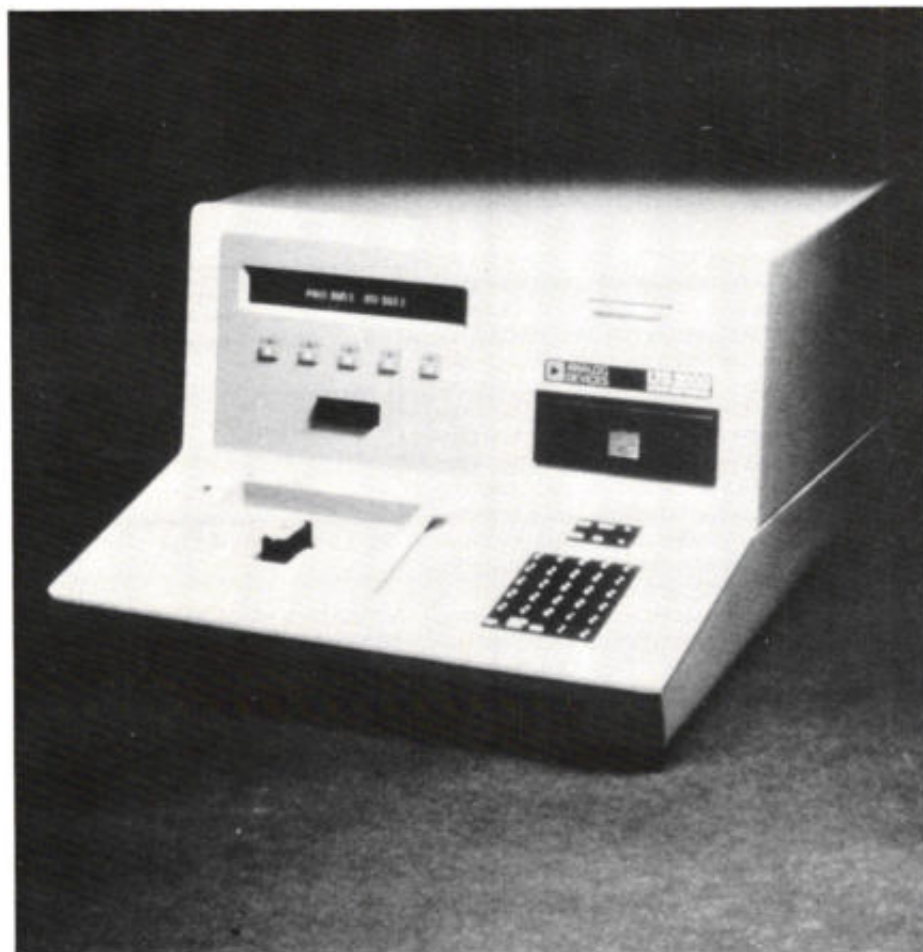
Het testsysteem LTS 2000 beschikt over een 16-bit CPU met 64 Kbyte geheugen en verschaft een meetnauwkeurigheid groter dan 16 bit \pm 1 LSB. D/A-, A/D-omzetters en versterkers met 12-bit nauwkeurigheid en resoluties tot 16-bit kunnen met het systeem worden beproefd. De uiterlijk identieke LTS 2010 is bovendien volledig programmeerbaar in uitgebreid BASIC.
