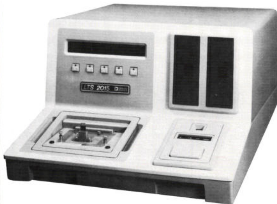
Het testsysteem LTS 2015 heeft gelijke specificaties als de systemen LTS 2000/2010, met ondermeer de volgende uitzonderingen. Voor meer flexibiliteit en opslagcapaciteit is een tweede diskette-loopwerk toegevoegd. Een numerieke processorkaart geeft een grotere verwerkingssnelheid, het alfanumerieke toetsenbord en de thermische printer zijn vervallen.
